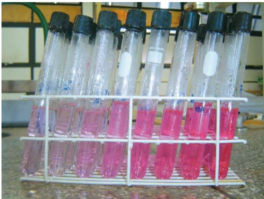
Figura 29 Tubos utilizados para determinação da curva padrão após o aquecimento
