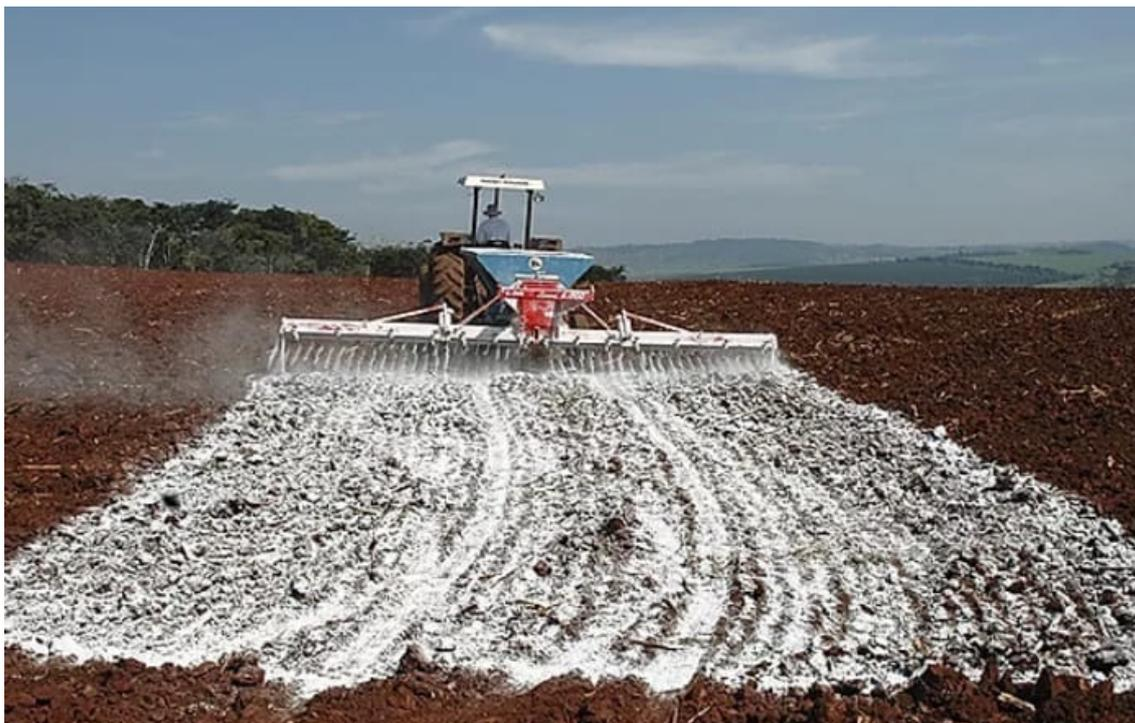
**Figura 10. Aplicação e distribuição uniforme de calcário**
