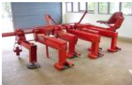
Figura 2. Componente da roçadora articulada com acoplamento das três facas.
