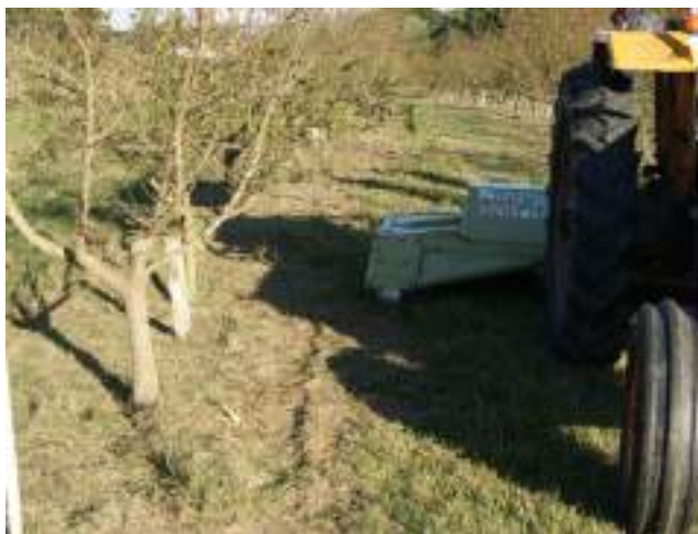
Figura 7. Roçadeira lateral, que joga o material roçado para a linha das plantas formando cobertura morta.
