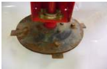
Figura 2. Componente da roçadora articulada com acoplamento das três facas.
