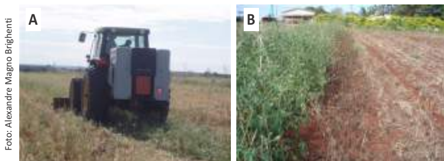
Figura 5. Equipamento Eletroherb capaz de produzir descarga elétrica a partir da rotação da tomada de força do trator, eliminando as espécies daninhas. Barra na dianteira para dessecação pré-semeadura (A). Área não dessecada-testemunha (esquerda) e área dessecada (direita) (B).
