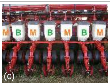
Figura 2. Etapas de implantação do consórcio milho-braquiária na modalidade da linha intercalar: caixa de sementes com discos e sementes de milho e de braquiária, respectivamente (a); discos para corte e posicionamento das sementes ao solo (b); depósitos para sementes de milho (M) e braquiária (B) (c); e, linhas intercaladas de milho em fase de colheita e de braquiária em pleno desenvolvimento (d).
