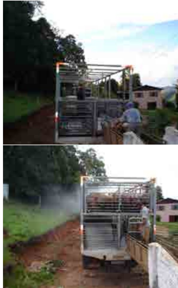
Fotos 5 e 6 – Método de embarque para suínos na granja utilizando o modelo do veículo com carroceria com piso hidráulico (móvel) e sistema de aspersão com água
