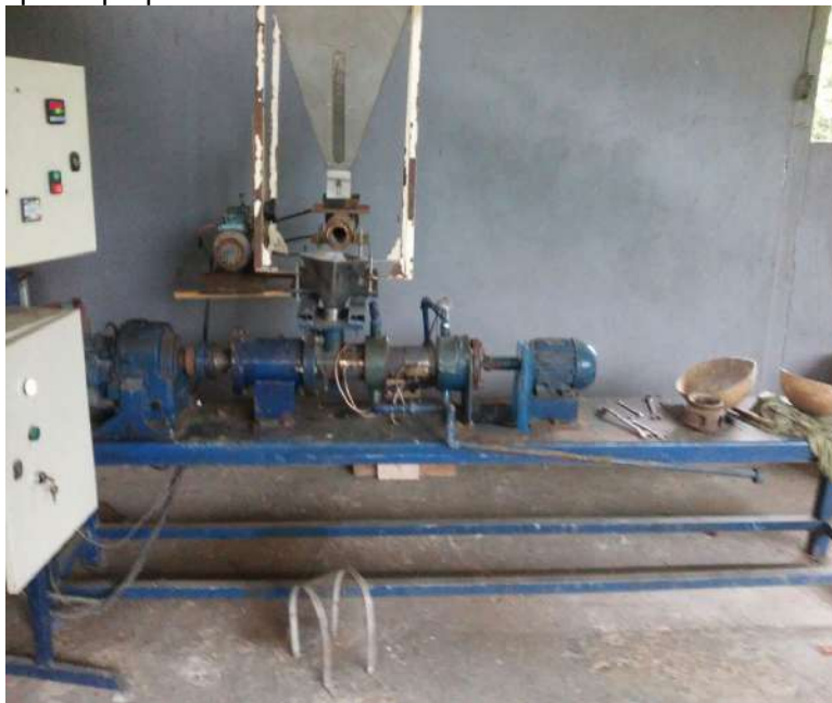
Figura 15 - Máquina extrusora para processamento de rações aquícolas em pequena propriedade rural
