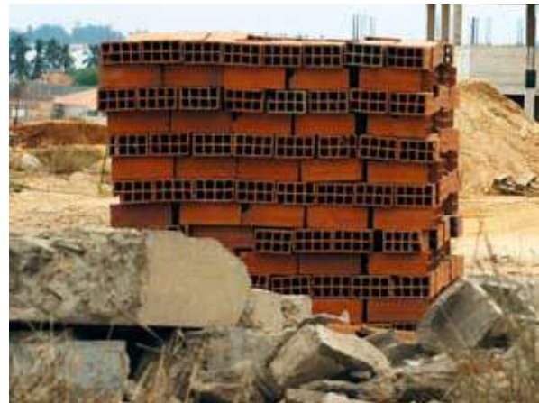
{ FIG. 3.27 } O uso de tijolo perfurado contribui para o isolamento dos edifícios. Nas fachadas, deve ser reforçado com material isolante, pelo exterior, ou na cavidade das paredes duplas.
