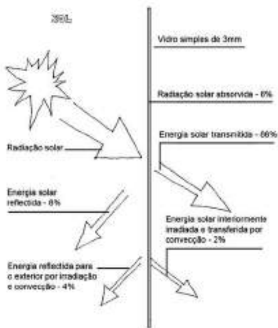
{ FIG. 3.32 } Troca energética numa janela de vidro simples de 3mm.
