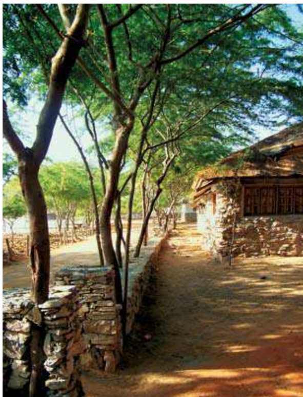
{ FIG. 3.56 } Exemplos de uso de vegetação em espaços exteriores: além de oferecerem sombreamento e contribuírem para a beleza do local, a vegetação também contribui para uma ligeira redução da temperatura local através do processo de evapotranspiração resultante da fotossíntese (arrefecimento evaporativo).
