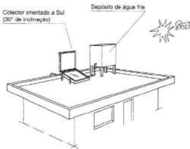
{ FIG. 5.3 } Localização do colector solar na cobertura do edificio.
