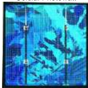
Figura 2.51 - Célula policristalina com AR e filamentos eléctricos Célula: Photowatt
