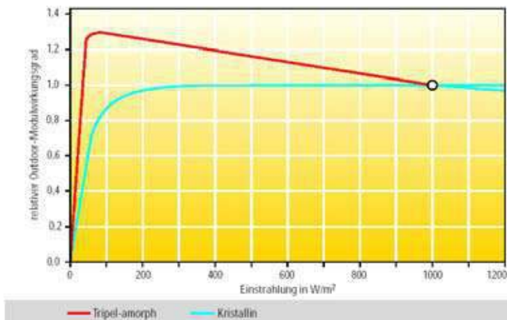
Figura 3.67 - Comparação entre a eficiência dos módulos amorfos de tripla junção e módulos cristalinos, instalados no exterior
