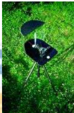
Figura 4.1 - Análise de sombreamento, utilizando uma câmara com acessórios especiais de geometria solar
