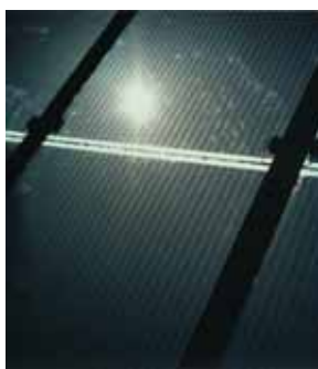
Figura 2.77 - Módulos de película fina semitransparente de silício amorfo
