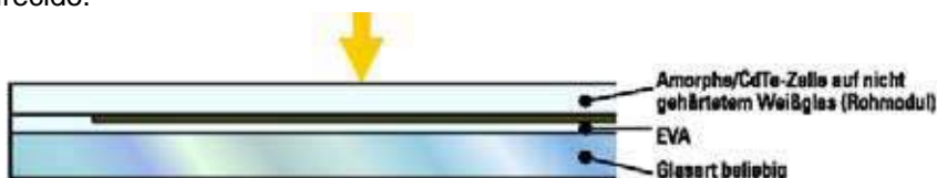
Figura 3.11 - Módulo vidro-vidro (células amorfas/CdTe em EVA)
