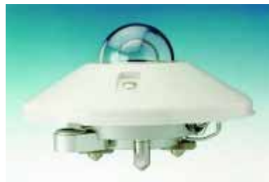
Figura 2.32 – Piranómetro [Kipp & Zonen Ltd.; fotografia: Lambrecht, Göttingen]
