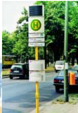
Figura 2.10 – Iluminação de uma paragem de autocarro com energia solar
