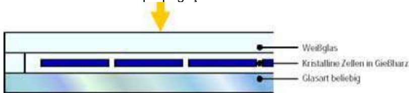
Figura 3.10 - Módulo vidro-vidro (resina fundida)
