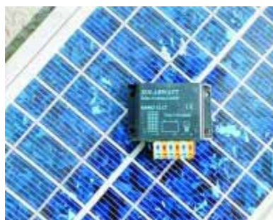
Figura 3.116 - Mini controlador de carga NANO Fotografia: Solarwatt
