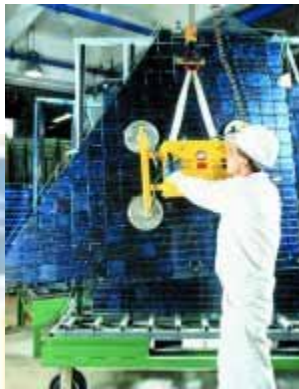
Figura 3.20 - Produção de um módulo específico em forma de trapézio Fotografia: Flabeg
