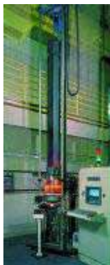
Figura 2.55 - Unidade de laminagem de faixas EFG (RWE Solar)
