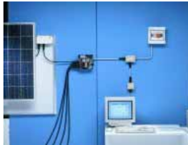
Figura 3.88 - Módulo AC com sistema de aquisição de dados operacionais e interface com um PC Fotografia: Dormüller
