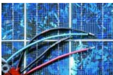
Figura 3.97 - Vários cabos de módulo e de fileira
