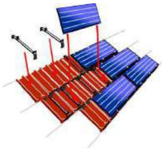
Figura 8.42 - Montagem dos grampos de retenção de aço inoxidável e módulos
