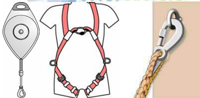
Figura 9.4 – Equipamento individual de protecção, Esquerda: Bloco de inércia, Centro: Cinto de segurança e Direita: Ancoragem dos cabos de suspensão
