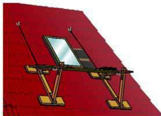
Figura 9.7 – Plataforma de trabalho
