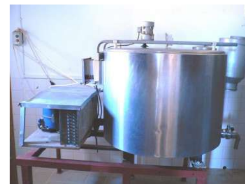
Tanque de refrigeração
