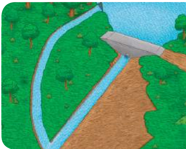
Vertedouro removendo o excesso de água da represa
