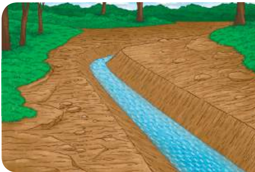
Canal escavado em formato trapezoidal, sem revestimento
