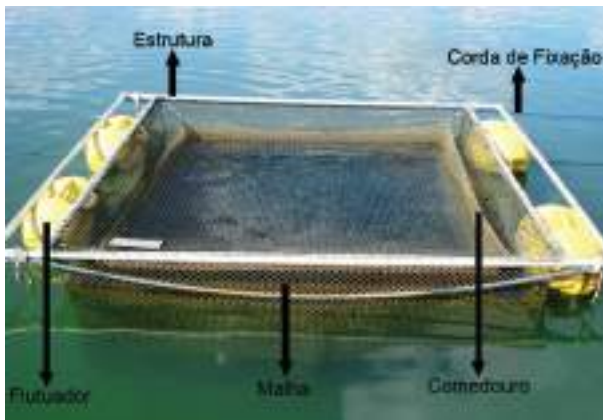
Figura 2 - Estruturas básicas de um tanque-rede
