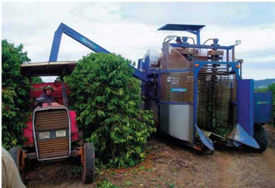
Colhedora automotriz com depósito lateral
