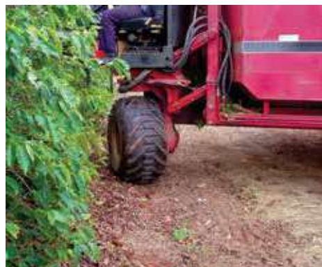
Detalhe: amplitude da conversão e rodagem larga que evitam compactação
