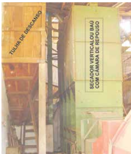
Secador Vertical tipo baú com tulha de descanso
