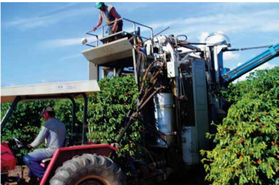
Colhedora tracionada: acoplada ao trator
