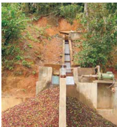
Lavador maravilha com bomba de recirculação de água
