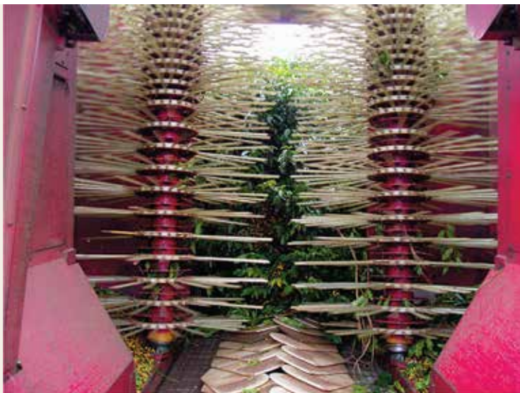
Retirada parcial das varetas inferiores
