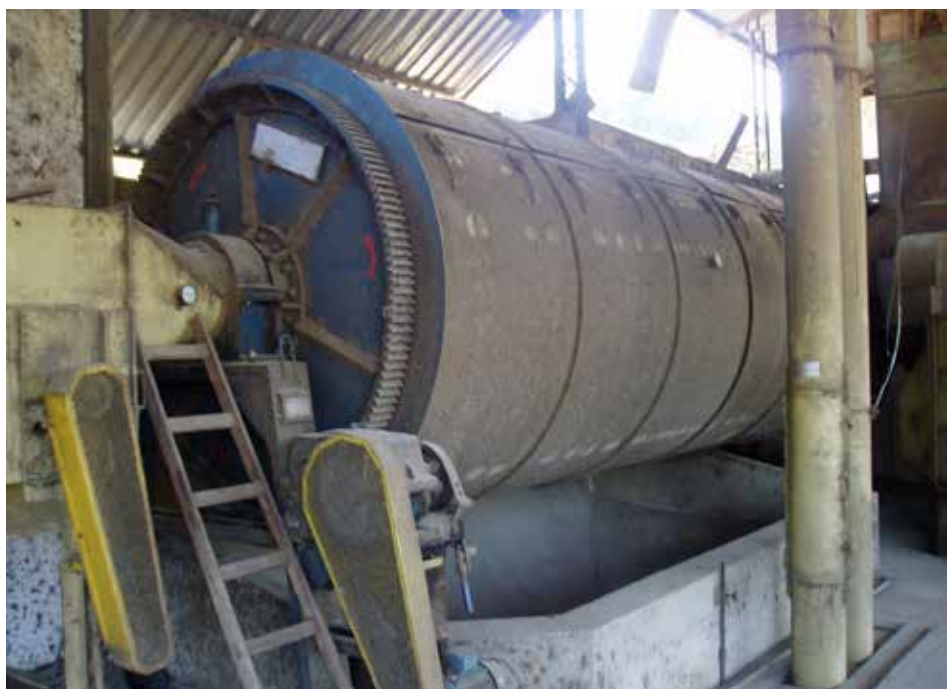
Secadores horizontais rotativos: detalhes da moega de descarga e dos protetores de polia
