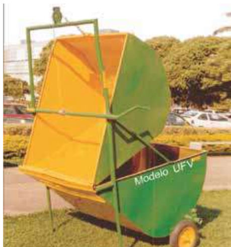
Lavador mecânico de acionamento manual – Modelo UFV
