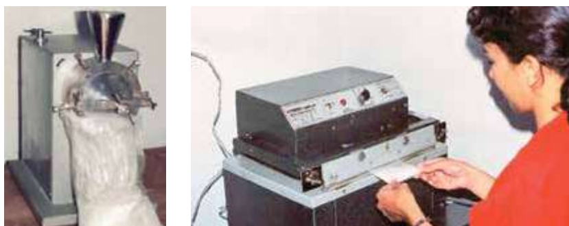
Figura 3. Moagem e Embalagem. Moagem da formulação molhável de Baculovirus (esquerda); Embalagem de baculovírus molháveis para aplicação em um hectare de milho (direita).
