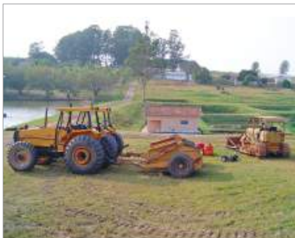
FIGURA 7 - Máquinas utilizadas para a construção dos viveiros (Scraper e trator de esteira)
