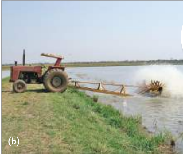
FIGURA 41 - Aerador elétrico com sistema de pás helicóide (a); aerador a trator (b)
